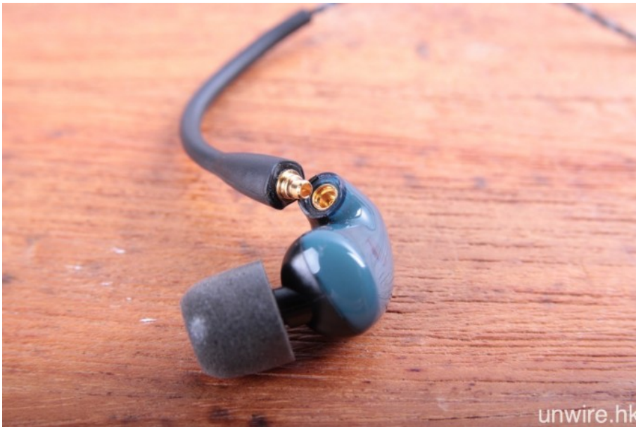
AF180 用上可換接線設計，接頭為 MMCX 規格。
