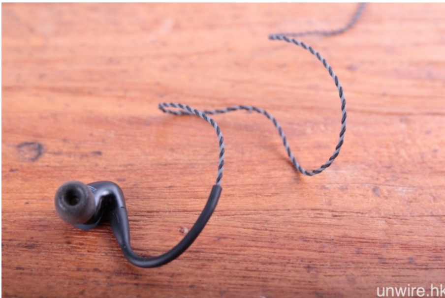
原裝附送的 Audioflex SL 接線，近耳機端為超輕巧的雙絞接線，減輕掛耳時的重量負擔。
